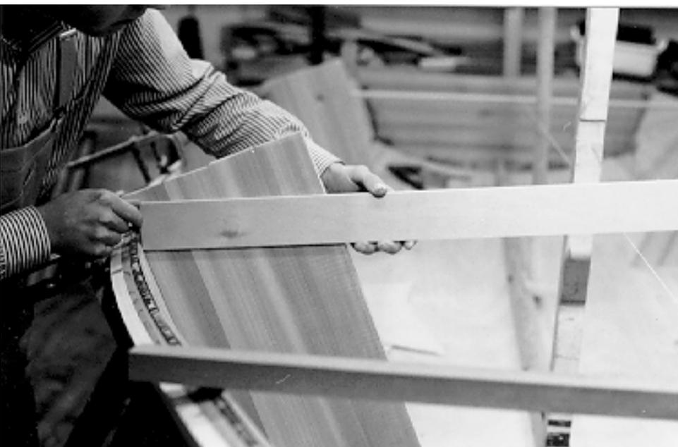
Mit einer Leiste kann die Decksneigung auf die Spanten übertragen werden.
