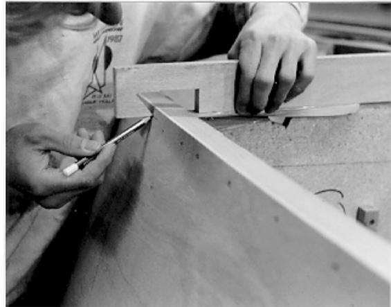
Dann müssen die Stringer an die Bodenform angepaßt werden. Im Heckbereich benötigt man dazu eine biegsame Straklatte.
