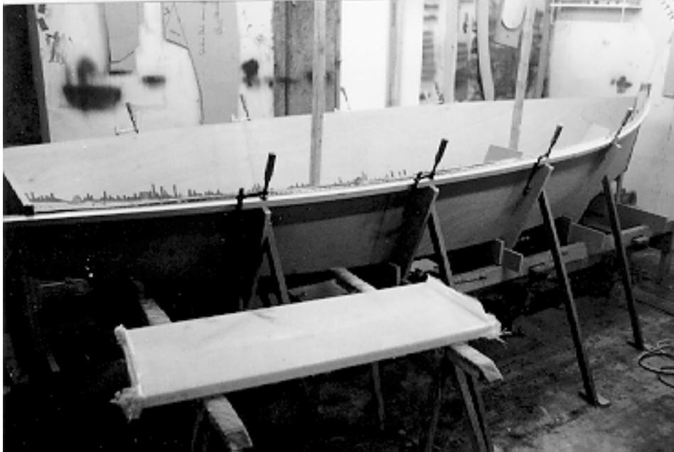
Wird nach der Methode mit fest eingebauten Spanten gearbeitet, ist dies nicht notwendig, da der Rumpf schon völlig fest ist. Wir haben die Spanten erst aus dem Rumpf entfernt, nachdem der Rumpf fest in seiner Form stand.
