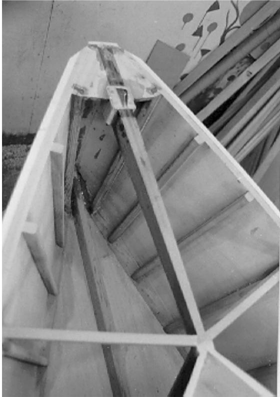
Im vorderen Bereich kann man die Aussteifungen der Seitenwände sehen, die den Rumpf in der Welle fester machen.
