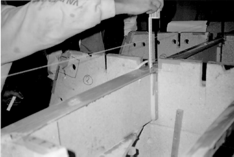
Achtung: Das fehlende Sperrholz berücksichtigen! Mit der Wasserwaage den senkrechten Einbau kontrollieren!
