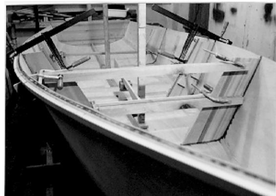
Da Zwingen schlecht angesetzt werden können, haben wir geschraubt. (Achtung, Verlauf der Spanten genau anzeichnen, um nicht daneben zu schrauben und die Position des Spants genau anzeichnen, damit er nicht verrutschen kann), Die Flucht mit dem Spant auf der anderen Seite stellt man am besten mit einem Kantholz her, das an den Spanten mit einer Zwinne befestigt wird.
