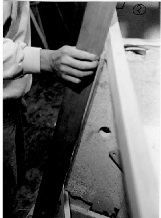
Trotzdem muß die Leiste montiert werden, damit die Kimmstringer im richtigen Winkel abgehobelt werden können. Dazu muß mit dem langen Lineal immer genau kontrolliert werden.
