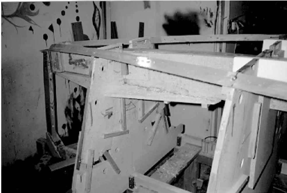
ACHTUNG: Für die Maße sind NUR die Klassenbestimmungen entscheidend. Die Pläne dienen nur als Hilfsmittel. Da bei den Vermessungspunkten Schnitt 2 und 4 keine Spanten vorgesehen sind, kann man dort eventuell Hilfsspannten, die wieder entfernt werden) vorsehen.
